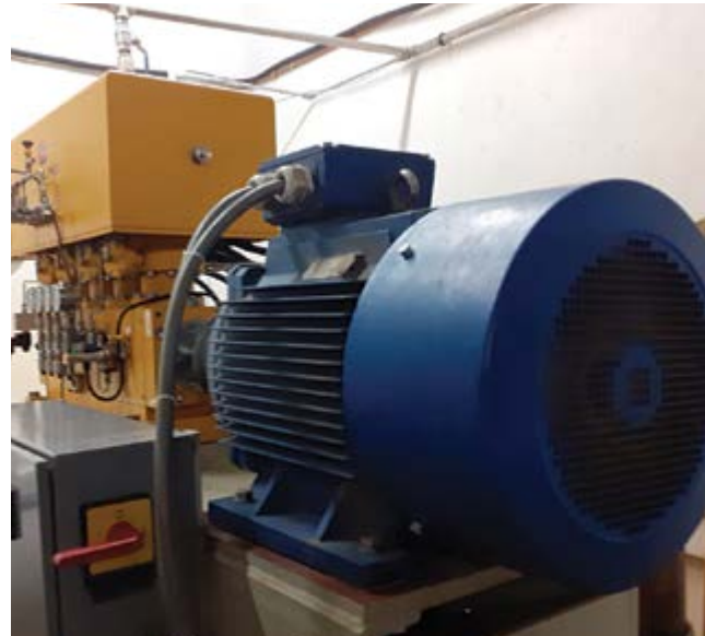
15. Τετρακύλινδρη Κρυογεννήτρια Παραγωγής Υγρού Αζώτου
