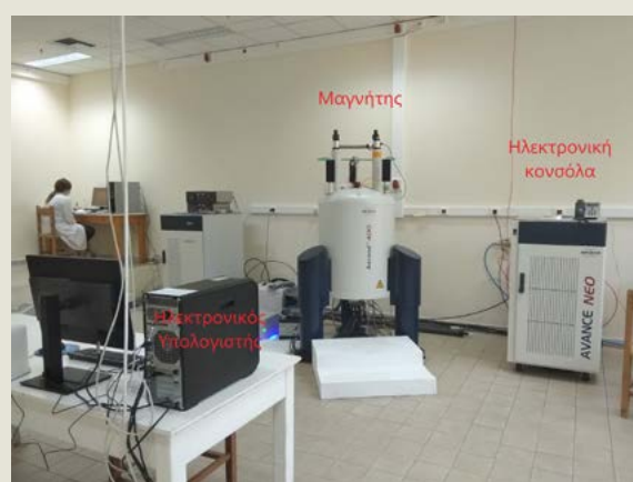
Τα φασματόμετρο Bruker Avance Neo 400 MHz και τα κύρια μέρη που το απαρτίζουν.
