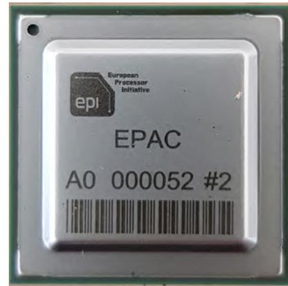
Πρώτο δοκιμαστικό chip του Ευρωπαϊκού Επεξεργαστή RISC-V
